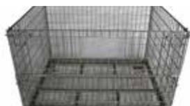
Eine Gitterbox oder Gitterboxpalette ist ein aus einer Stahlrahmen-Gitter-Konstruktion bestehendes Ladehilfsmittel in der Fördertechnik. Vier FüÙe ermöglichen die Aufnahme der Gitterbox mittels eines Gabelstaplers oder eines Handhubwagens von allen vier Seiten. Zur Stapelung der Boxen sind Stellwinkelaufsätze angebracht.
