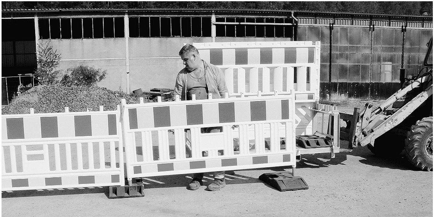
Das Kombipalettensystem KPA 20 S verkleinert das Risiko des Unternehmers durch die kompakte Lagerung und den Transport der zusammengehörenden Absicherungen. Foto: HMR
