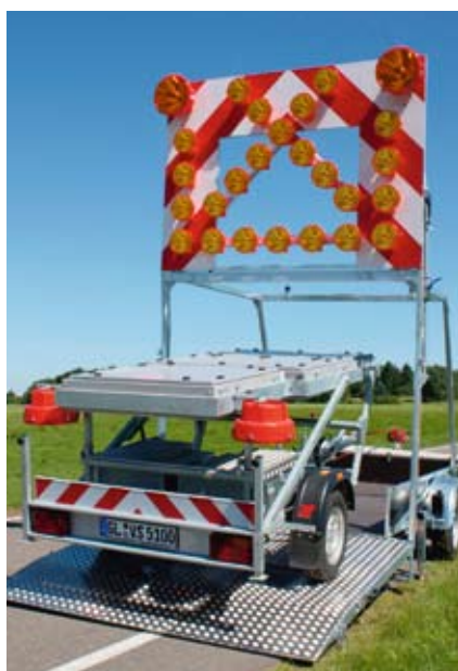
Die neue fahrbare Absperrtafel AM 4 TL ist serienmäßig mit elektrisch aufrichtendem Tafeloberteil und befahrbarer Ladefläche versehen.
