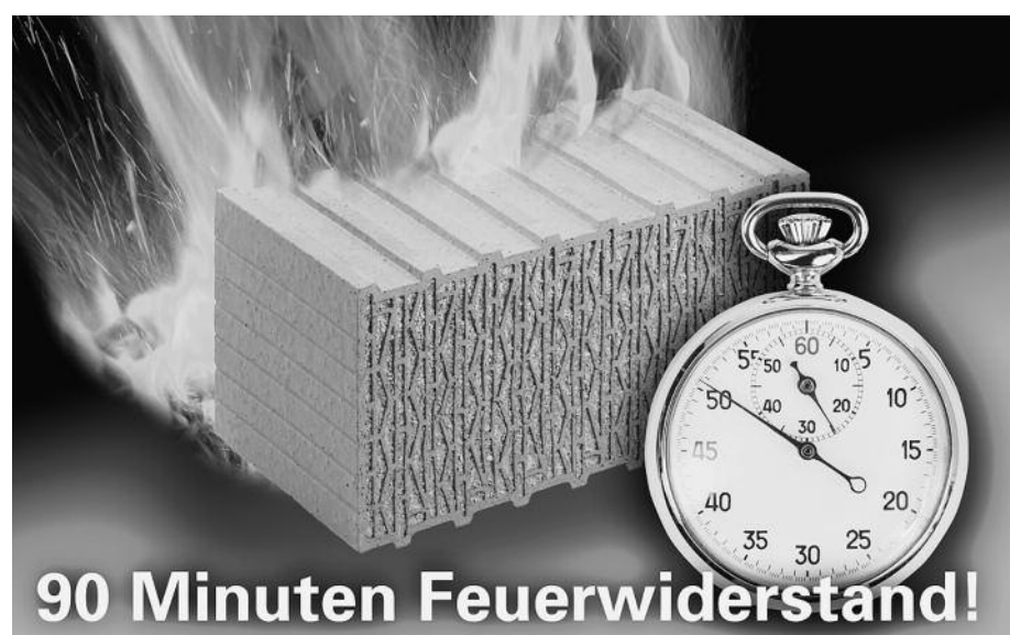
Viele Mauerziegel bieten nachweislich mindestens 90 Minuten Feuerwiderstand. Foto: Unipor
