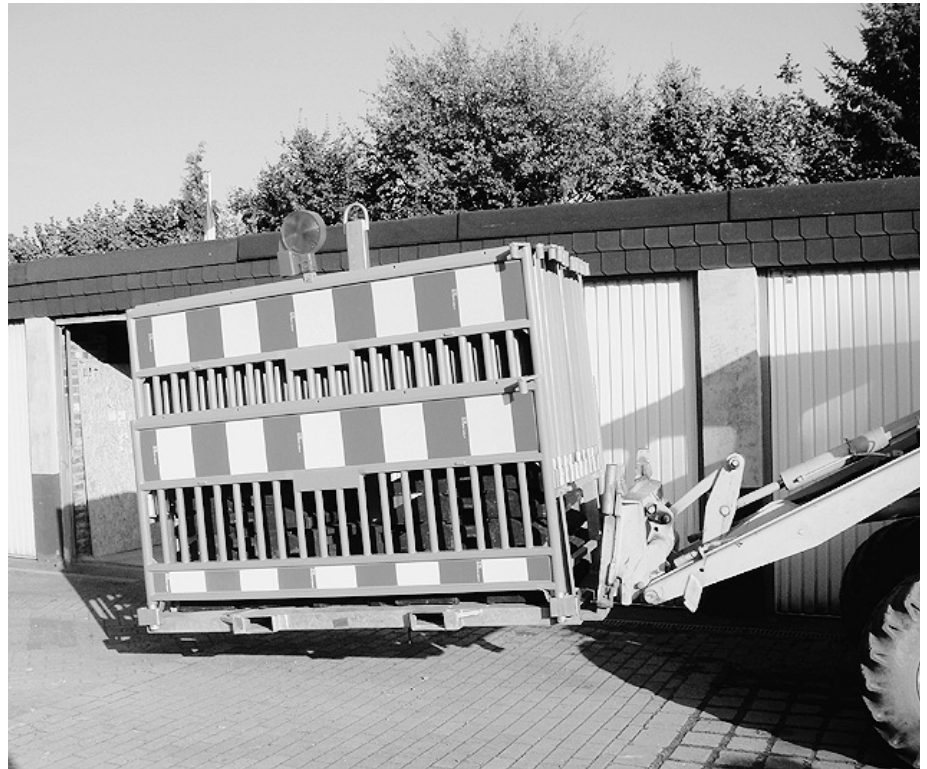
Auf der Multi-Kombipalette KP 22 M – K (kurzer Arm) haben 20 Zäune und 20 RC-Füße Platz. Diese können komplett mit einem Stapler auf- und abgeladen werden. Fotos: HMR
