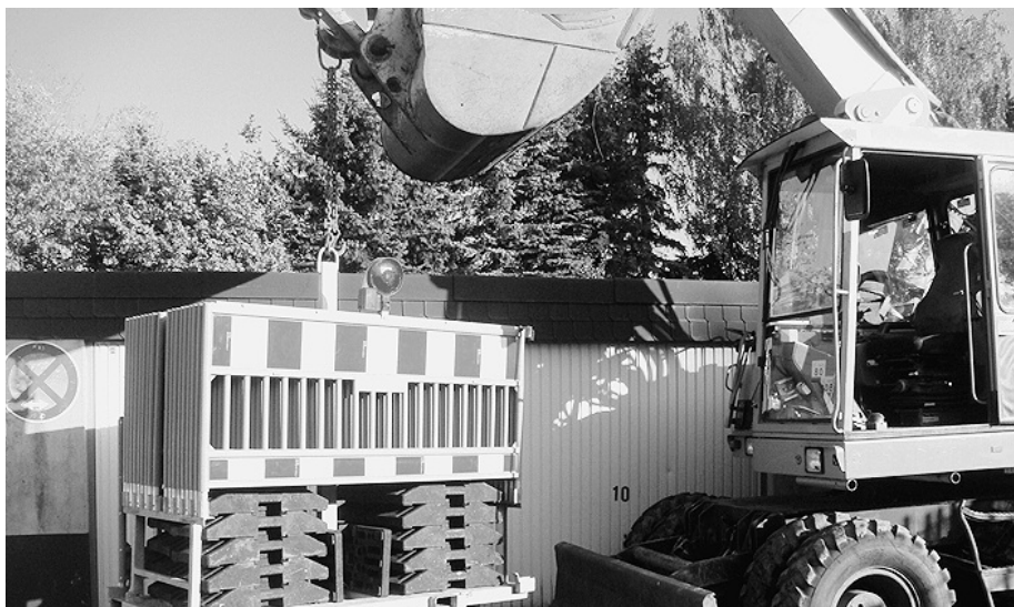
Die Palette KPA 22 M kann mit der Zusatzausrüstung, dem Kranhaken, auch von einem Bagger transportiert werden. Fotos: HMR
