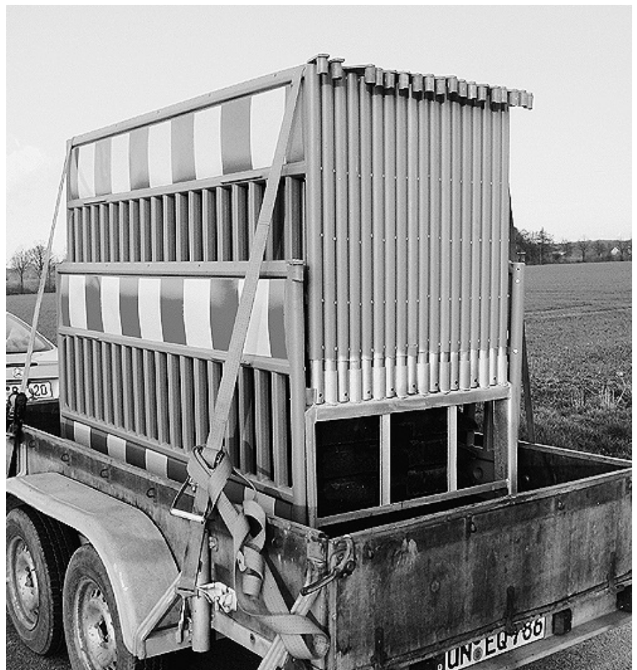
40 m Absturzsicherungen und Fußplatten K 1 passen auf einen Pkw-Anhänger.
