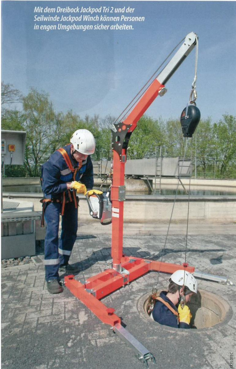
chanismen und Sicherungsbolzen mit einem portablen Fuß verbunden werden. Er lässt sich stufenweise auf Höhen von 2,2 m bis 3 m einstellen. Auf- und Abstieg einer Person lassen sich auch hier durch eine zweite Person über die Seilwinde steuern.
